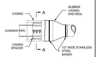
TYPICAL STEEL CASING INSTALLATION
